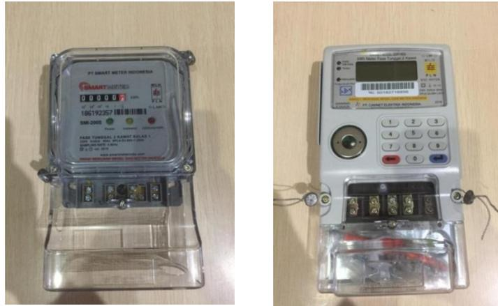
a. Kwh meter 1 phasa semi digital    b. Kwh meter 1 phasa digital
