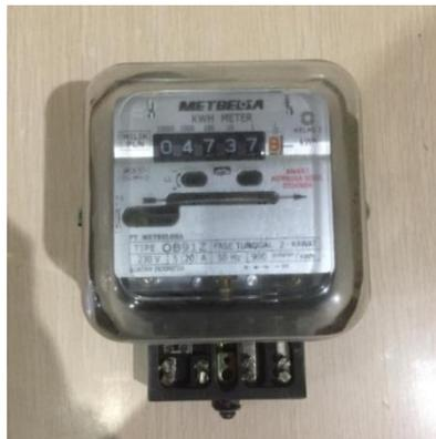
c. Kwh meter 1 phasa analog
