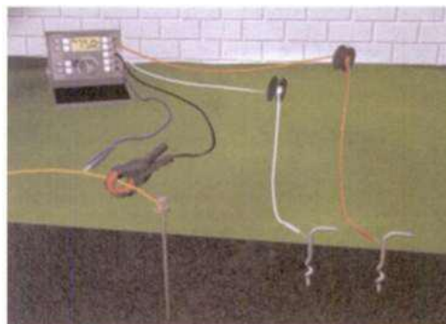
Gambar 2.8 Penggunaan Transformator Arus Jepit.
