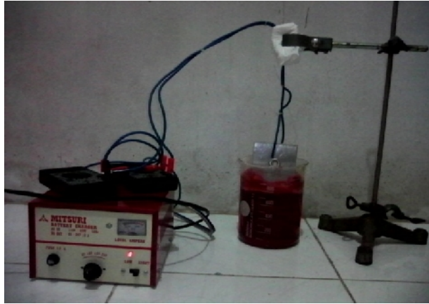
(a) (Proses Pengolahan Limbah dengan Menggunakan Metode Elektrokoagulasi )
