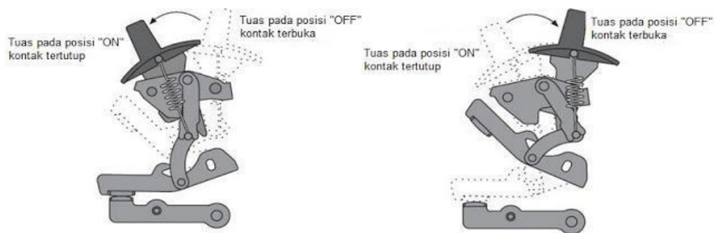
Gambar 2.8 Tuas PMCB dalam posisi terbuka ( open )
