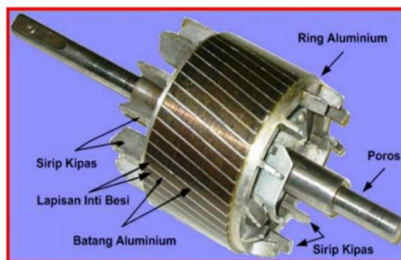
Gambar 2.2. Rotor Sangkar
