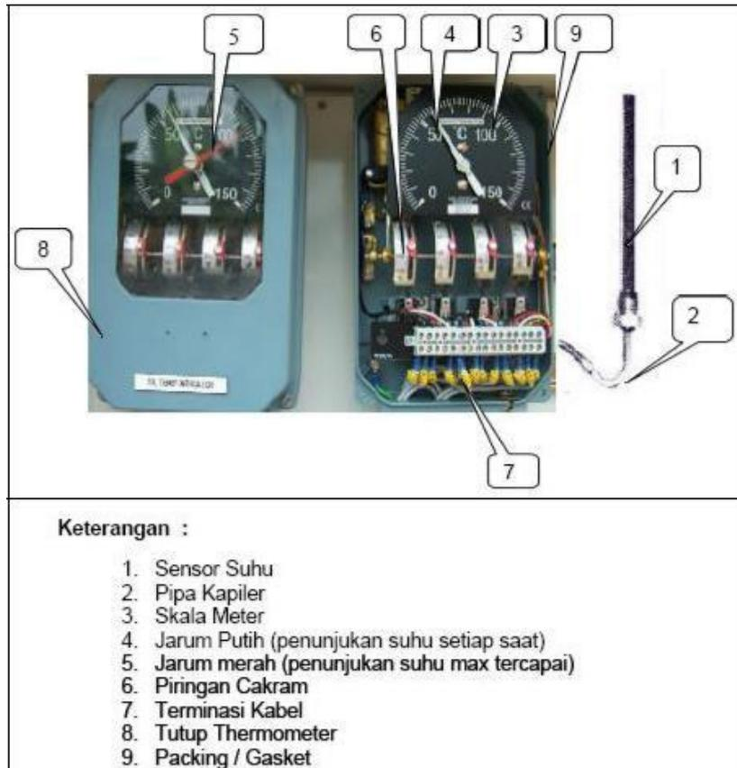
Gambar 2.30 Bagian – Bagian dari *Rele Thermal*<sup>5</sup>
