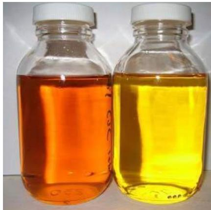
Gambar 2.21 Minyak Isolasi Trafo <sup>5</sup>
