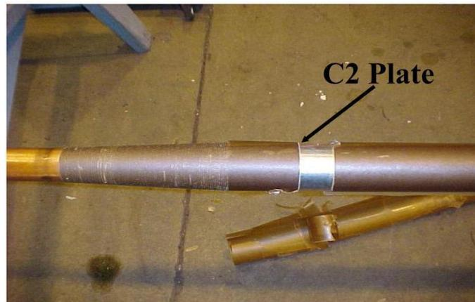
Gambar 2.13 Konduktor Bushing Dilapisi Kertas Isolasi <sup>5</sup>
