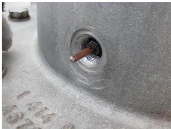
Gambar 2.16 Tap Pengujian <sup>5</sup>
