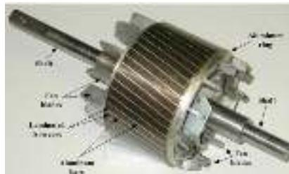
Gambar 2.11. konstruksi rotor sangkar motor induksi
