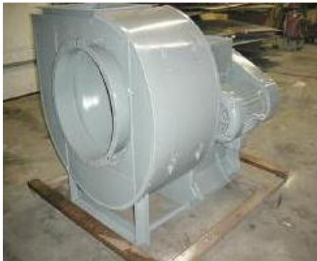
Gambar 2.10 *Blower* Sentrifugal (*Fan Air Company*)
