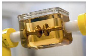
Gambar 2.16 Minyak Isolasi Trafo Tenaga [11]
