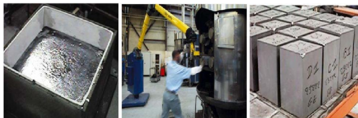
Gambar 2.13 Metode Casting Pembuatan Bahan Polikristal
