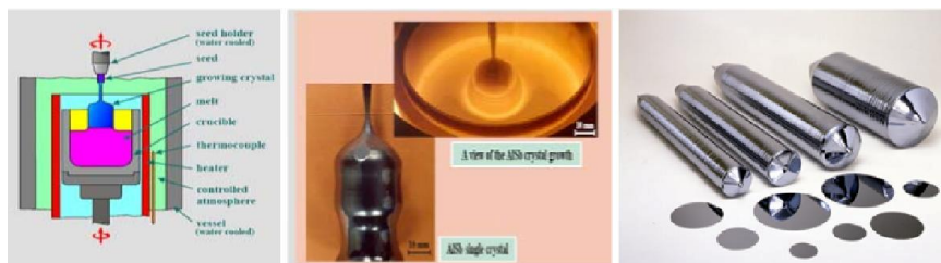
Gambar 2.11 Metode penumbuhan kristal mono Czochralski
