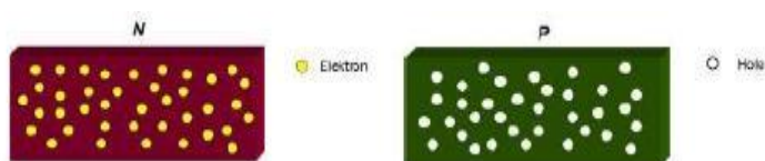
Gambar 2.4 Semikonduktor Tipe-P dan Tipe-N
