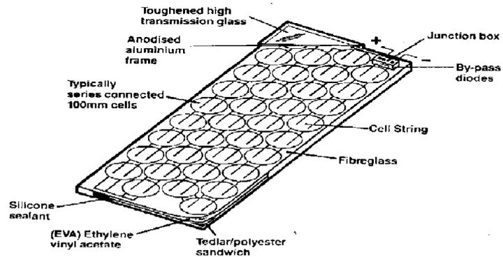
Gambar 2.17 Konfigurasi sebuah modul fotovoltaik.
