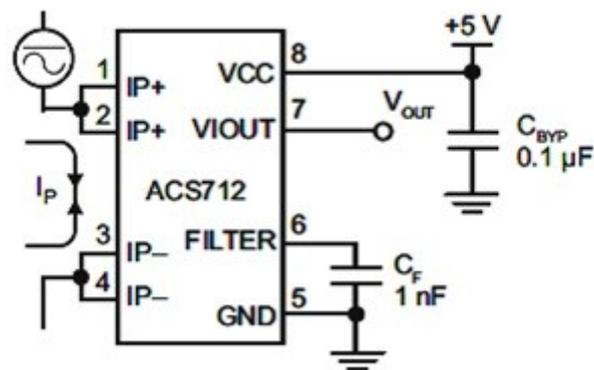
**Gambar 2.26 Rangkaian skematik sensor arus ACS712**
