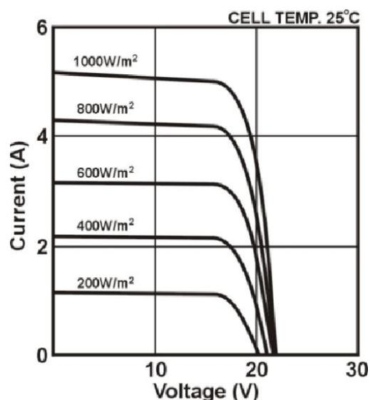
Gambar 2.20 Karakteristik Photovoltaic
