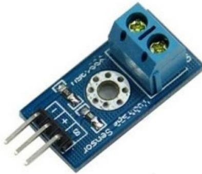
**Gambar 2.23 Modul sensor tegangan**
