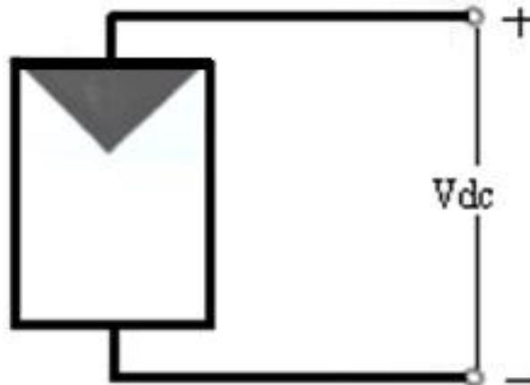
Gambar 2.2 Simbol Yang Diberikan Untuk Photovoltaic.
