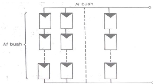
Gambar 2.18 Rangkaian seri-paralel PV
