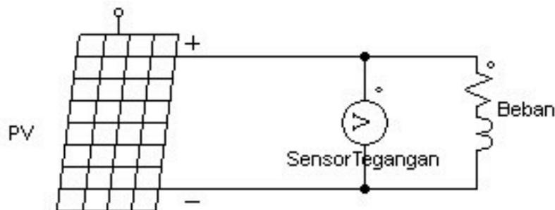
**Gambar 2.24 Bentuk rangkaian sensor tegangan untuk mengukur tegangan beban pada Panel Surya**
