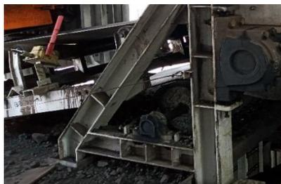
Gambar 2.14 Back Stop atau Hold Back
