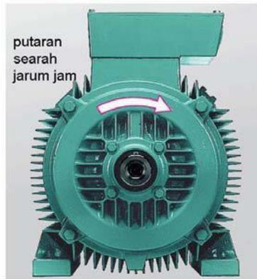
Gambar 2.12. Arah putaran motor induksi<sup>3</sup>
