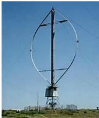
Gambar 2.4 Turbin Angin Sumbu vertikal
