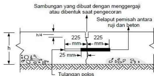
Gambar 2.22 Sambungan Susut Melintang dengan Ruji
