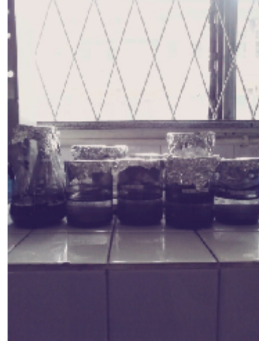
Gambar 17. Perendaman Karbon Aktif dengan H_3PO_4
