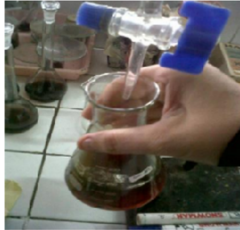
Gambar 25. Analisa Bilangan Iod
