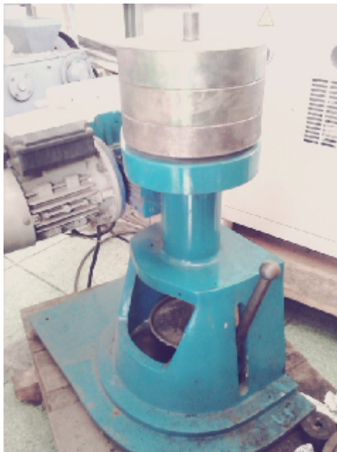
Gambar 14. Proses Grinding di HGI
