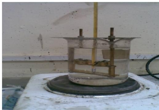
**Gambar 6. Pengujian Titik Lembek**
