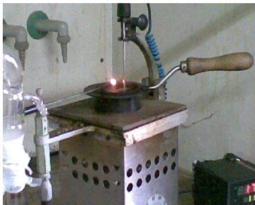
**Gambar 5. Pengujian Titik Nyala dan Titik Bakar**
