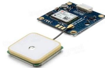
**Gambar 2.3** Modul GPS Neo-6M [12]
