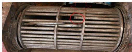
Gambar 2.3 *rotor bar* yang patah
