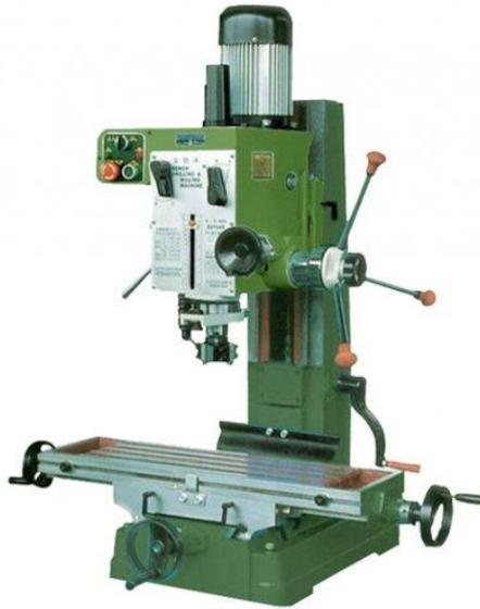
Gambar 2.23 Mesin Bor Lantai
