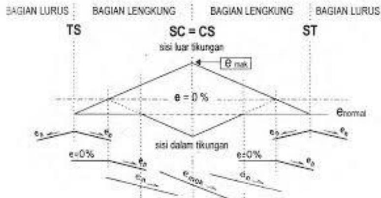
Gambar 2.7 Pencapaian superelevasi pada tikungan tipe SS
