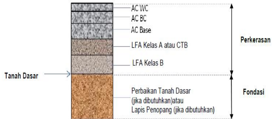
Gambar 2.26 Perkerasan Lentur Pada Permukaan Tanah Asli
