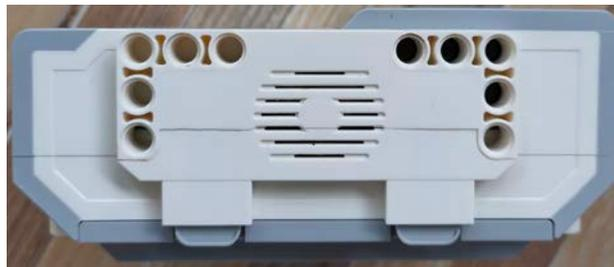
**Gambar 2.7** Sisi Kanan *EV3 Brick*
