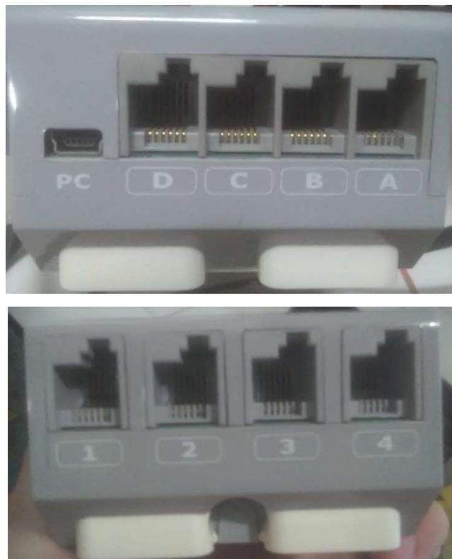
**Gambar 2.16** *Input dan Output EV3 Brick*
