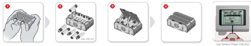
**Gambar 2.17** Instalasi menggunakan baterai AA
