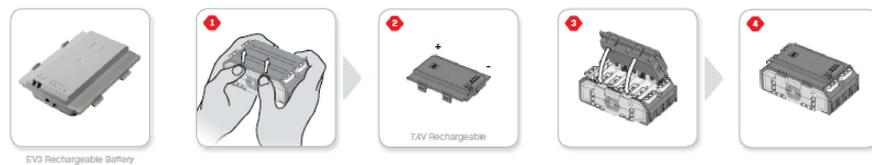
**Gambar 2.18** Instalasi menggunakan EV3 *Rechargeable Battery*
