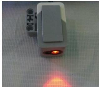
**Gambar 2.12** Sensor Warna dalam *Reflected Light Intensity Mode*
