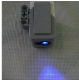
**Gambar 2.13** Sensor Warna dalam *Ambient Light Intensity Mode*
