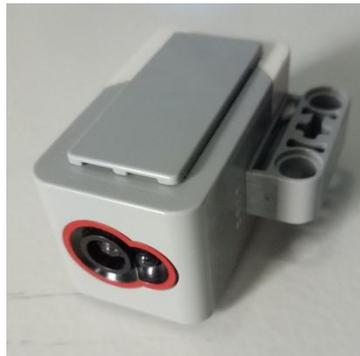
**Gambar 2.11.** Sensor Warna (*Colour Sensor*)
