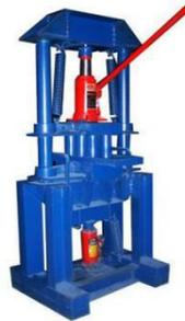
Gambar 2.1 Alat Press Briket Menggunakan Sistem Hidrolik
