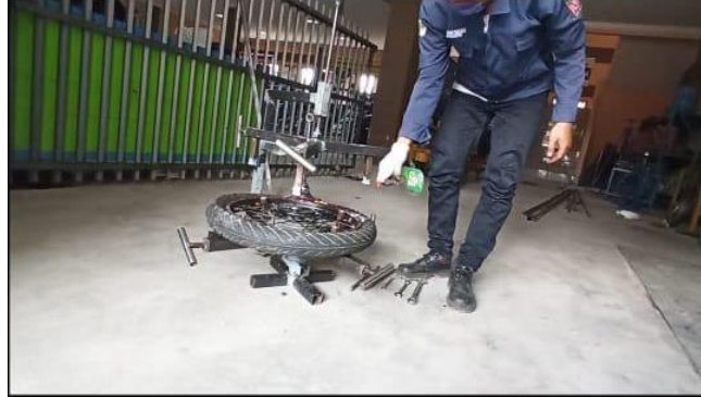
Gambar 5.6 Proses Pembersihan Vleg (Sumber; Dokumentasi)
