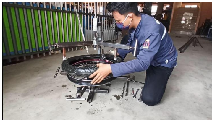
Gambar 5.7 Proses Pembukaan Ban (Sumber; Dokumentasi)
