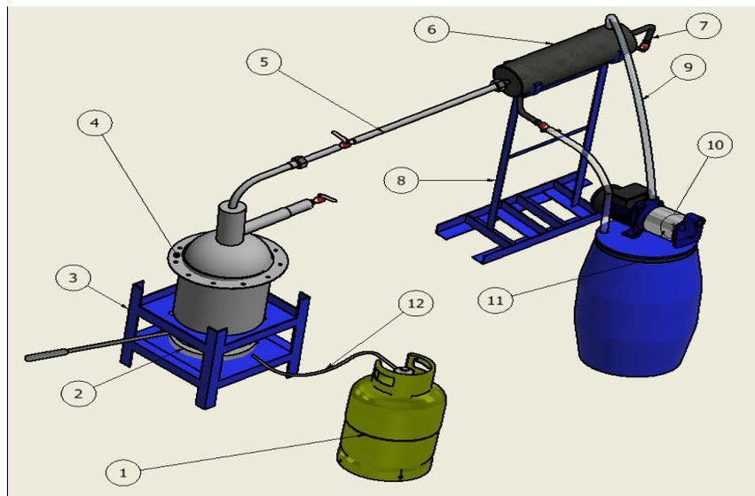
Gambar 2.3 : Sket Mesin Alat Pirolis Menjadi bahan bakar minyak
