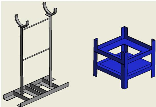
**Gambar 2.4** Sket Kerangka Kondensor dan Reaktor
