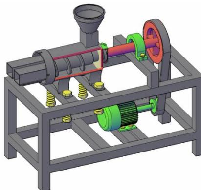
**Gambar 2.11** Alat Untuk Mencetak Briket
