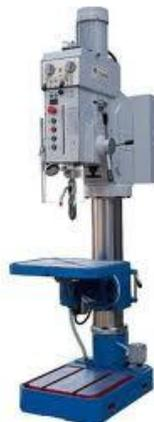
**Gambar 2.9** Mesin Bor Tegak
