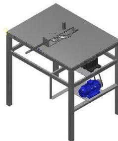
Gambar 2.2.3 Mesin *bending* pipa menggunakan motor
