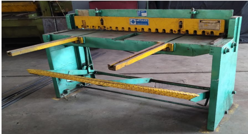
Gambar 2.3 Mesin Gullotine Manual (Sumber: Bengkel Mekanik Teknik Mesin Politeknik Negeri Sriwijaya)
