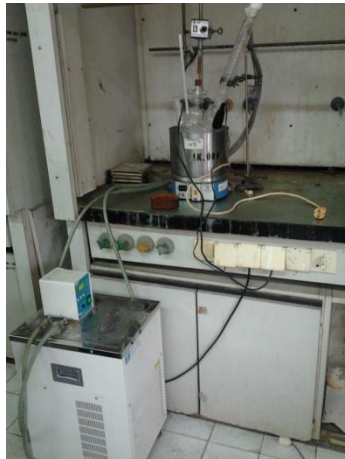
Gambar 18. Rangkaian Alat Hidrolisis Tepung Tapioka (lengkap)
