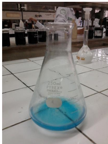
Gambar 26. Penambahan aquadest dan larutan Luff Schoorl ke dalam sampel yang telah diencerkan dengan aquadest
