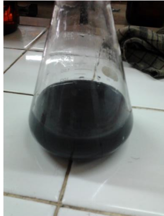
Gambar 30. Larutan Sampel Mencapai Titik Ekuivalen Titrasi, lalu ditambahkan 3 tetes indikator larutan Kanji
