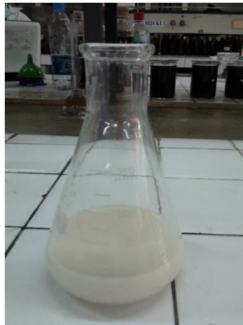
Gambar 31. Larutan Sampel Mencapai Titik Akhir Titrasi
