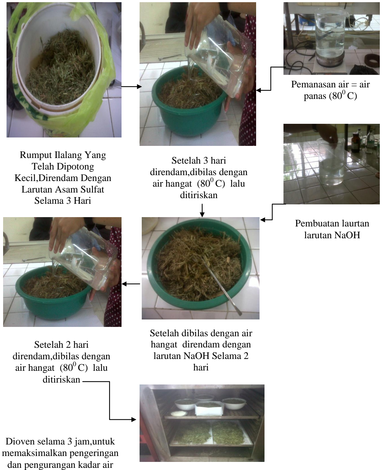
Gambar C.5. Diagram Alir Proses Pretreatment Dengan Perendaman Asam
