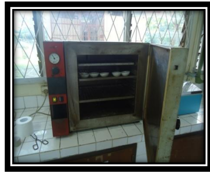
Semua sampel plastik dipanaskan dalam oven pada suhu 100-110°C
