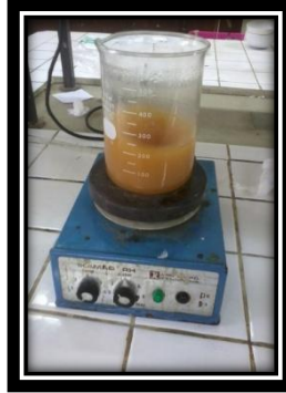
Minyak jelantah, Air, katalis NaOH (Transesterifikasi)
