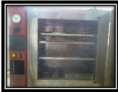
Pengeringan dalam oven pada suhu 70°C -80°C
