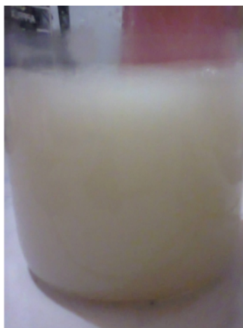
Gambar 27. Hasil Pencampuran Natrium Silikat + Natrium Aluminat
