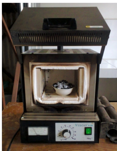
Gambar 21. Proses Peleburan Abu Terbang Batubara + NaOH di dalam Furnace
