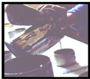
Aspal Murni yang telah cair
