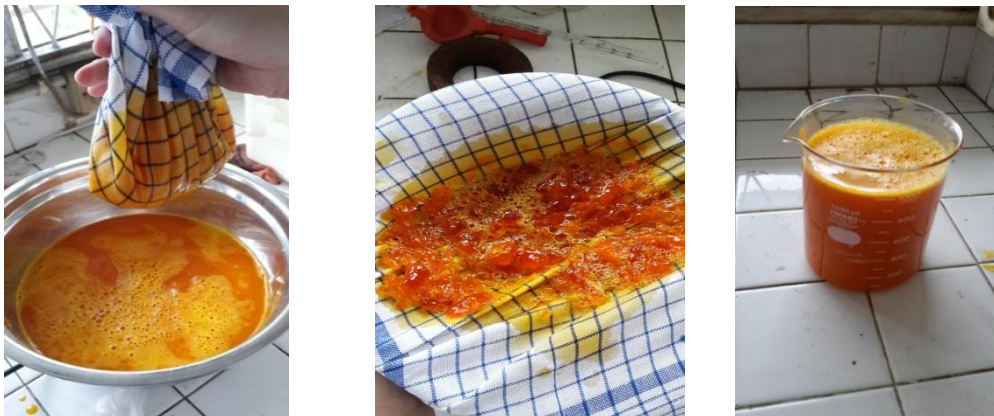
(a). Setelah proses pengenceran dilakukan penyaringan bagian yang tidak larut (b). bagian yang tidak larut (c). Produk akhir sabun cair
