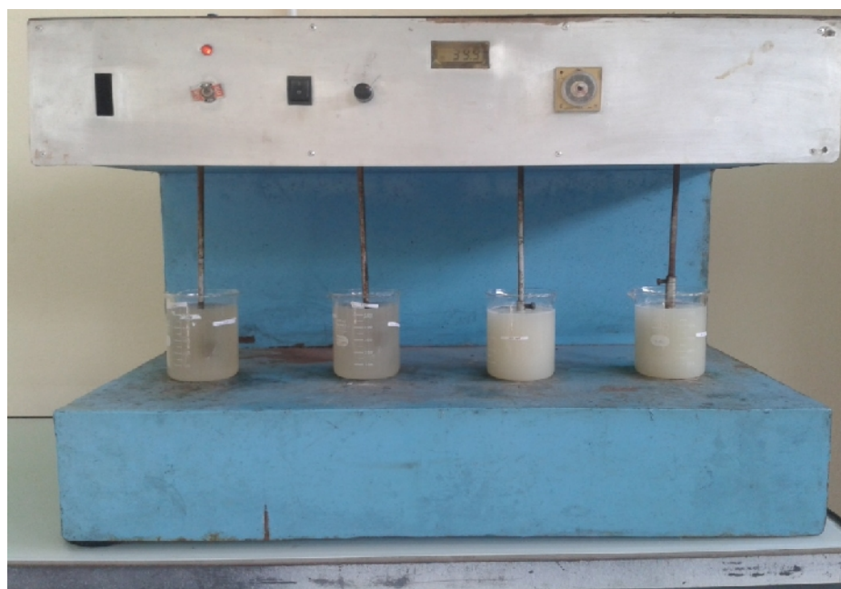
Gambar 13. Pengolahan Limbah Cair Tahu Menggunakan Koagulan Biji Asam Jawa dengan Jar Test
