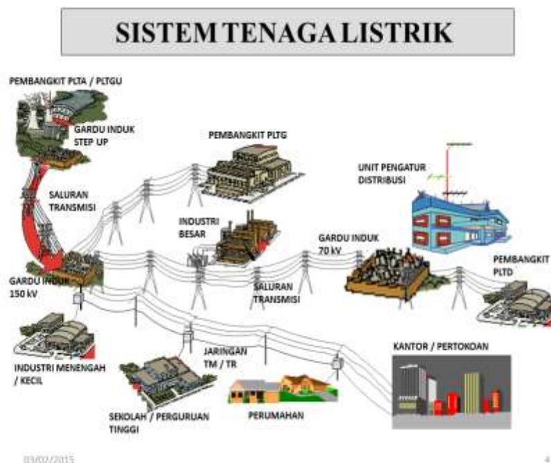
Gambar 2.1 Sistem Tenaga Listrik
