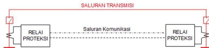
Gambar 2. 10 Prinsip Kerja Skema Perbandingan Arus
