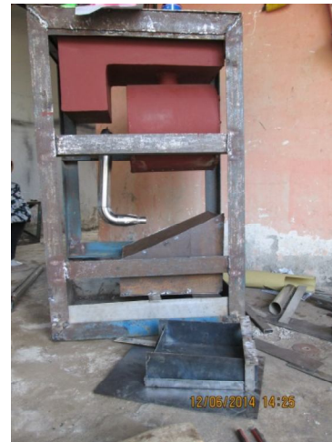
Pemasangan Cerobong Primary Chamber dan Tutup Absorben
