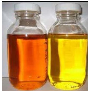
Gambar 2.14 Minyak isolasi trafo
