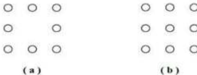
Gambar 2.6 Elektroda tanah : (a) Dalam susunan segi empat kosong, (b) Dalam susunan segi empat terisi
