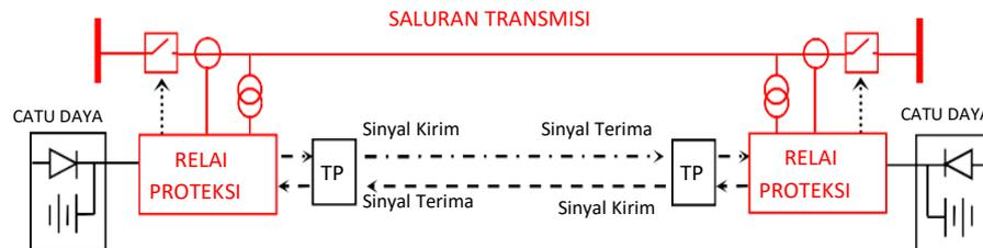
**Gambar 2.6** Typical Komponen Sistem Proteksi SUTT
