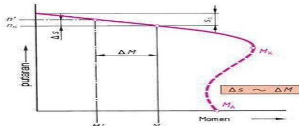
Gambar 2.9 Karakteristik putaran fungsi torsi
