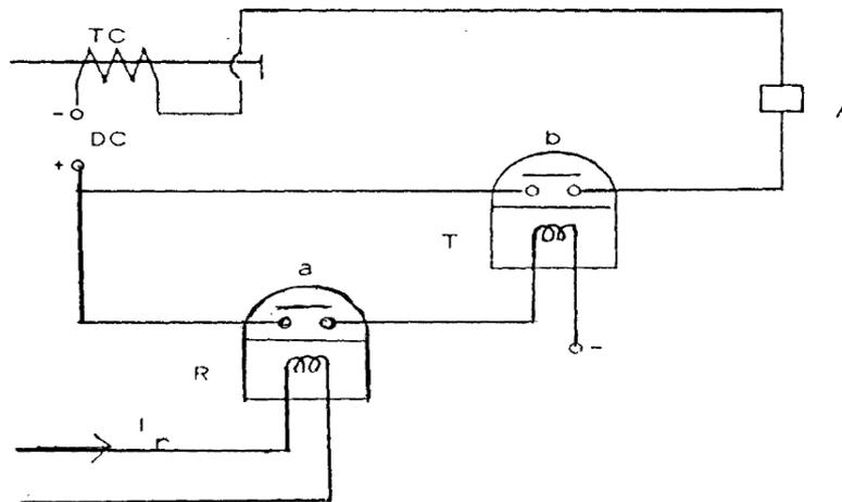
**Gambar 2.10.** Rangkaian Relay Arus Lebih dan Relay Waktu
