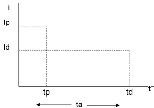
**Gambar 2.11.** Karakteristik Operasi Arus Pick-Up dan Drop-Off
