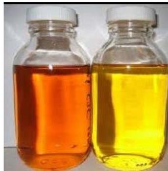
Gambar 2.14 Minyak isolasi trafo
