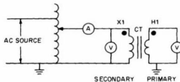
**Gambar 2.28 Pengujian Ratio dengan Metode Tegangan**
