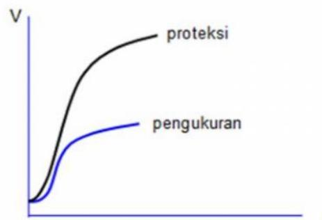
**Gambar 2.13 Kurva kejenuhan CT untuk Pengukuran dan Proteksi**
