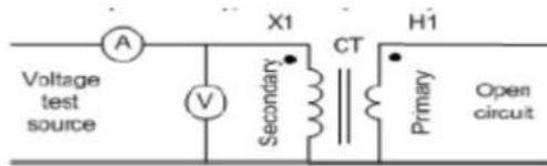
**Gambar 2.26 Rangkaian Pengujian Eksitasi**
