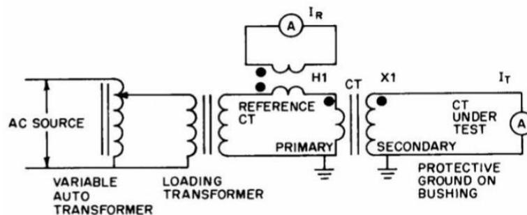
**Gambar 2.29** Pengujian Ratio dengan Metode Arus
