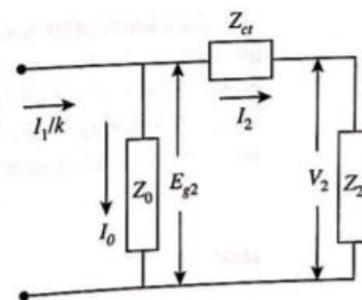
**Gambar 2.11** Rangkaian ekuivalen dilihat dari sisi primer
